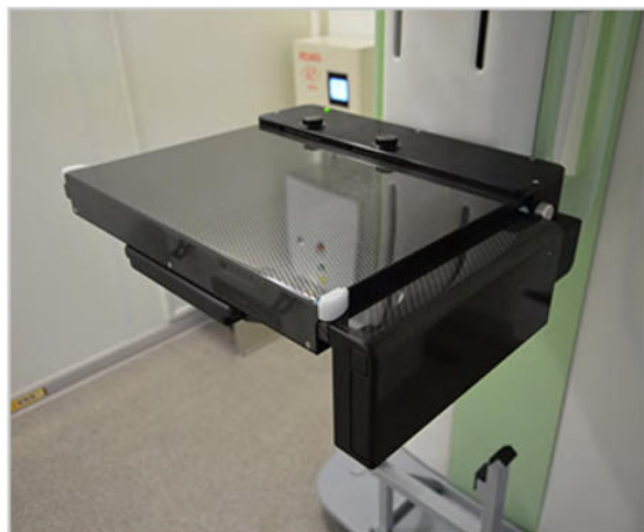
Рис. 3. Детектор «СОЛО ДМ-МТ», установленный в штатный кассетоприемник 24 \times 30
