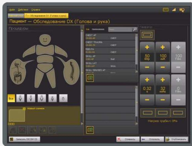
АПМ рентгенолаборанта основан на съемном планшетном компьютере со специализированным ПО. Данные могут быть опубликованы на АПМ врача-рентгенолога или сервере PACS через традиционную кабельную сеть или беспроводной канал связи по протоколу DICOM. Интерфейс пользователя на русском языке.
