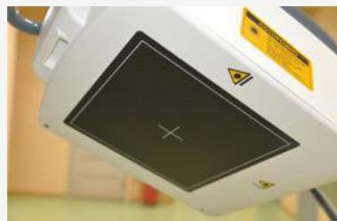
Плоскопанельный цифровой динамический приемник
